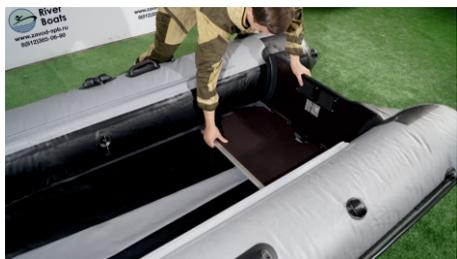
**6** Вставьте кормовую секцию настила в транец лодки. Кормовой пайол должен заходить под упорную планку на транце.
