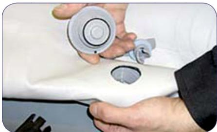
**3** В том случае, если воздух травит по контуру клапана, его необходимо сильнее затянуть этим же ключом по аналогии.
