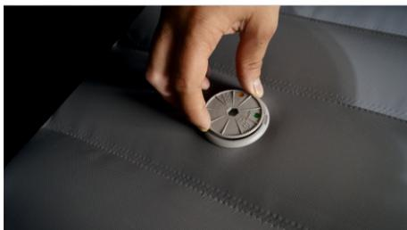
**3** Клапан сброса давления обязательно поверните до положения OPEN, чтобы избежать разрыва перегородок на воде
