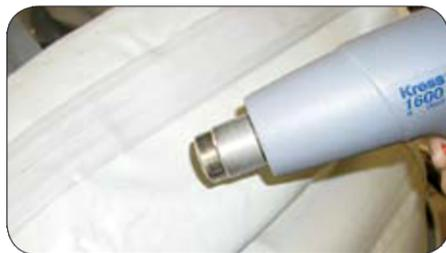
**4** Нанесите два равных, тонких слоя клея с интервалом в 5 минут на поверхность лодки и заплатки. Подождите 10-15 минут после второго нанесения, прежде чем приложить заплатку. Разогрейте склеиваемые поверхности с помощью фена до 40° - 45°С. В полевых условиях можно воспользоваться зажигалкой или положить заплатку на горячий неработающий двигатель автомобиля.
