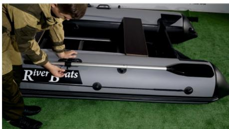
**16** Вставьте весла в уключины и зафиксируйте их, закрутив круглые пластиковые колпачки. После этого закрепите их в соответствующих креплениях.
