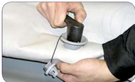
**2** После этого, вкрутите на это место другую исправную часть клапана.
