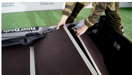
**4.2** Приподнимите две последние секции настила и удалите их. Выньте секции настила, сняв в последнюю очередь секции носовой части.
